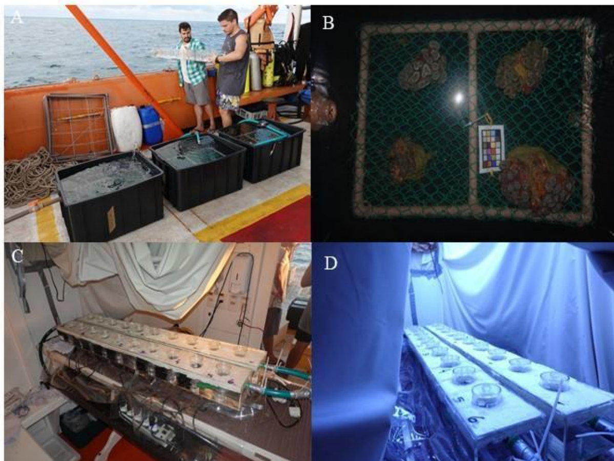
Figura 527: Sistemas utilizados nos experimentos-piloto de transposição de corais. A) Sistema aberto para transporte de um sítio para outro, B) Ramalhetes alocados no sistema aberto sendo transportados no período noturno, C-D) Sistema fechado de incubação para a realização de medidas fisiológicas.
