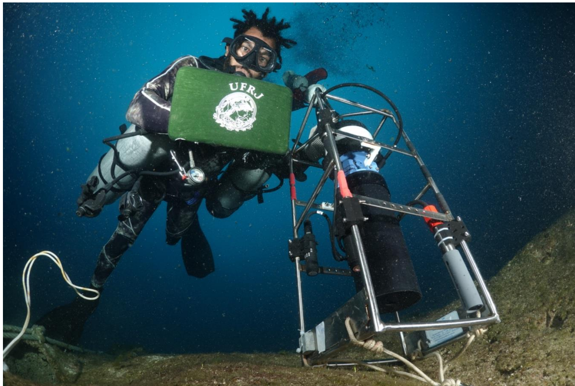
Figura 358: Recuperação de um fundeio multiparamétrico após 24h de submersão junto ao fundo recifal
